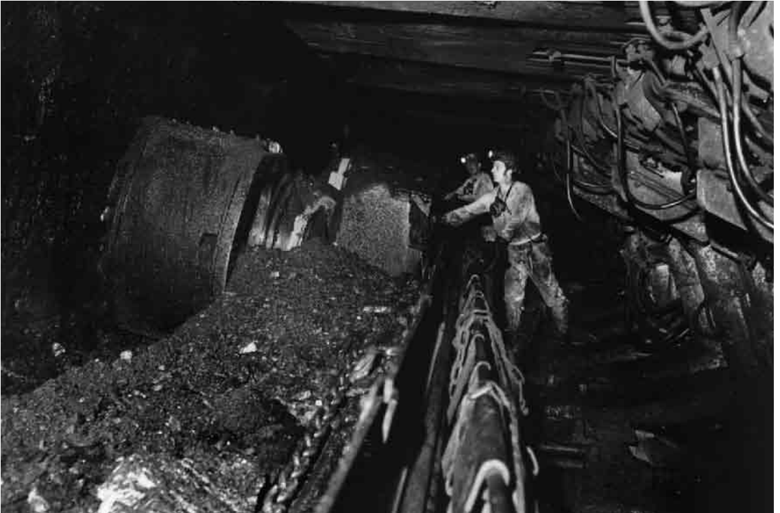
Technik im Saarbergbau: Streb mit Schildausbau und Walzenschrämlader (ohne Angabe).
