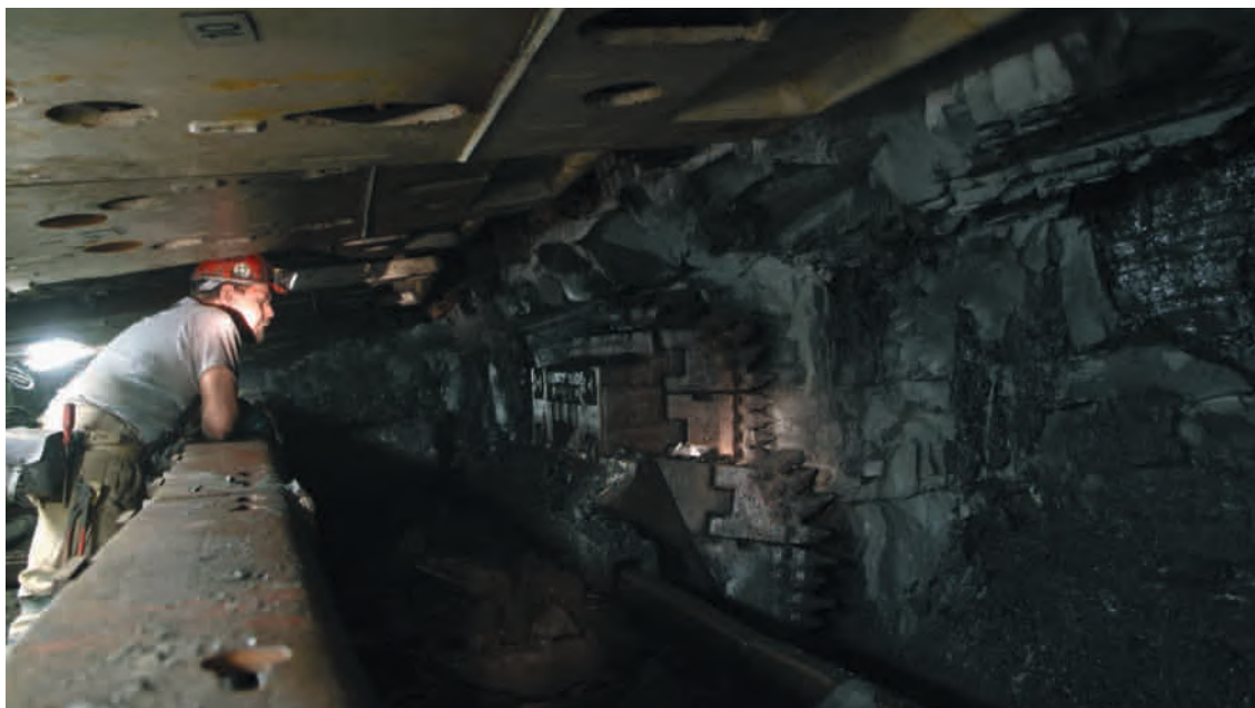
Kohlehobel im Einsatz – neue Technik auf dem Bergwerk Saar (2011).
